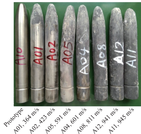
图 3 侵彻前后钛合金弹形状对比
