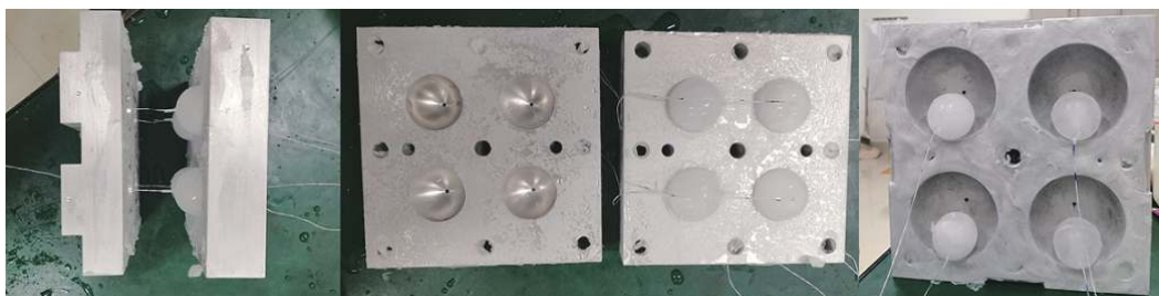
图 4 小冰球在大冰球模具中的定位方法
