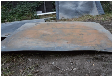
图 11 优化后基板变形实验结果
