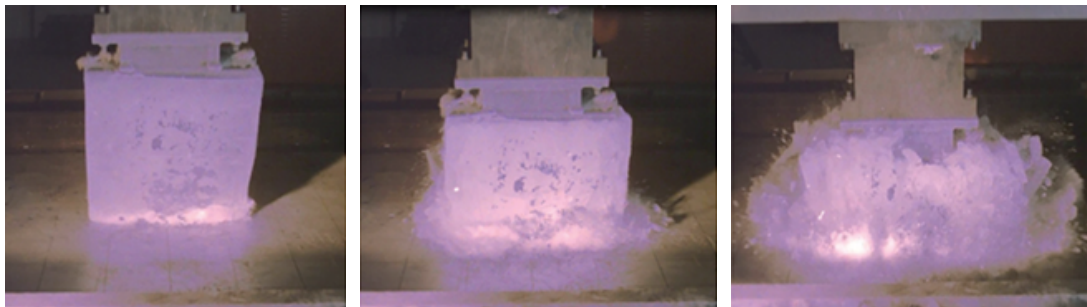
图 8 撞击过程中的冰体破碎过程
