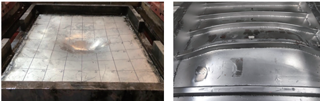
图 10 抗冰结构板架变形
