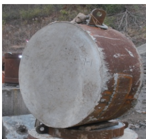
图 1 实验用素混凝土靶
