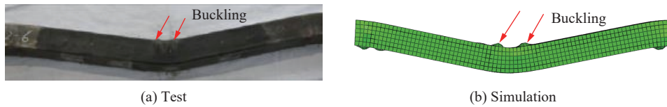
图 7 构件 NC-0.3-6 试验与模拟破坏形态对比
