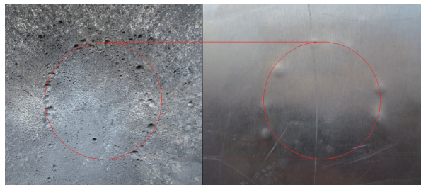
图 10 实验 7 后板弹坑环状分布图(PTFE/Al 防护屏)
