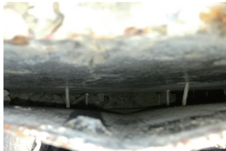
图 14 SCS 试件的栓钉拔出
