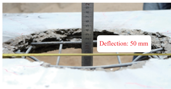
图 10 RCS 试件钢筋的最大挠度
