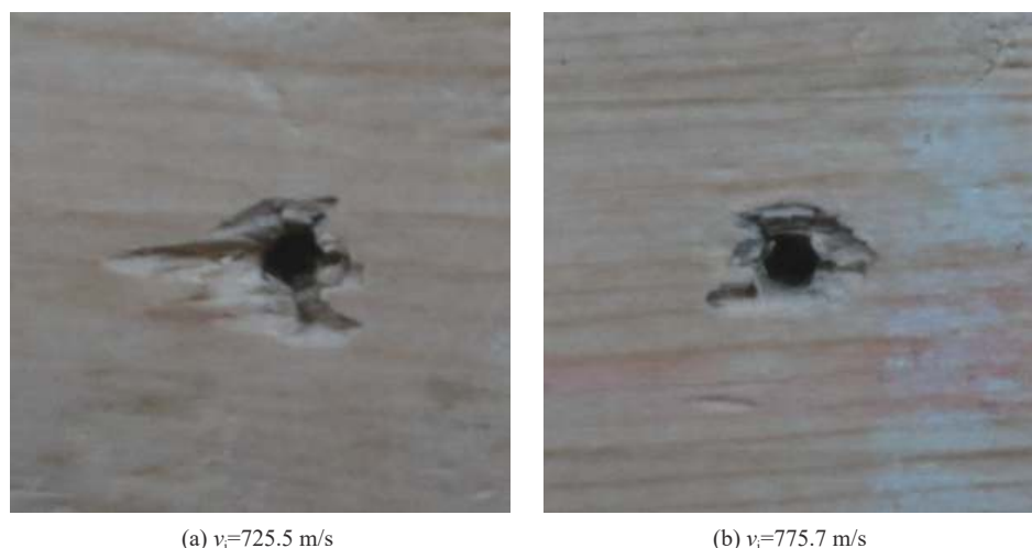
图 9 不同侵彻速度下松木靶背面的损伤形貌
