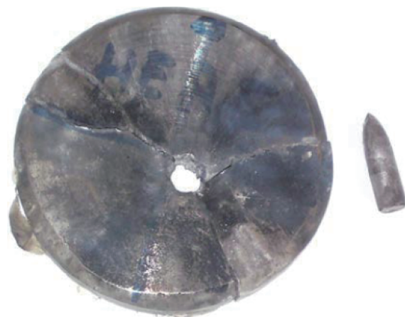
图 37 7.62 mm×39 mm 钢芯穿甲燃烧弹后的高熵合金靶板 [60]
