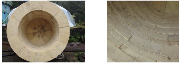
图 4 聚氨酯泡沫桶 Fig. 4 Polyurethane foam tank
