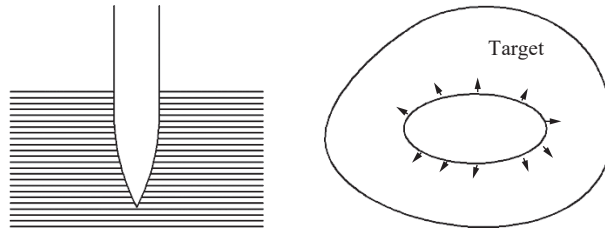
图 28 椭圆孔受力状态示意图 [73]
