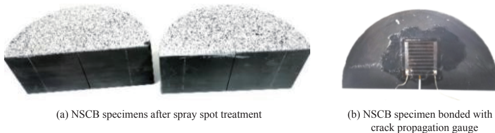
图 3 实验所用页岩 NSCB 试件
