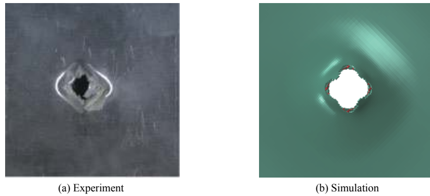
图 6 实验与数值模拟的纤维金属层合板背面破坏形貌
