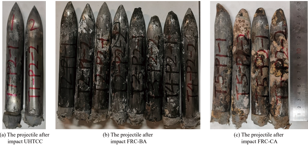
图 9 试验后回收的弹体
