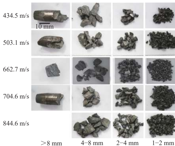
图 9 回收的弹体碎片 Fig. 9 Recovered projectile core fragments
