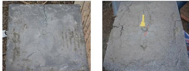
图 5 聚氨酯泡沫铝夹层(左)和泡沫铝夹层(右)受破坏情况对比
