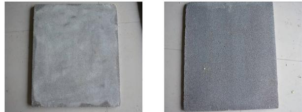
图 1 聚氨酯泡沫铝板(左)和泡沫铝板(右)对比(尺寸: 1 m×1 m)
