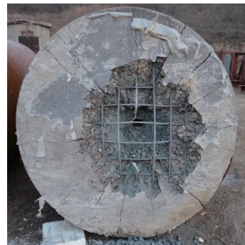
图 2 钢筋混凝土靶成坑形态 [15]
