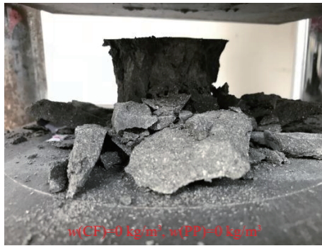
图 3 材料严重剥落
