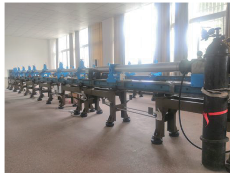
图 5 分离式 Hopkinson 压杆试验装置
