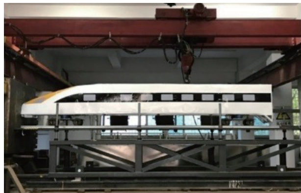
图 7 列车碰撞 1 : 8 缩比模型 [51]
