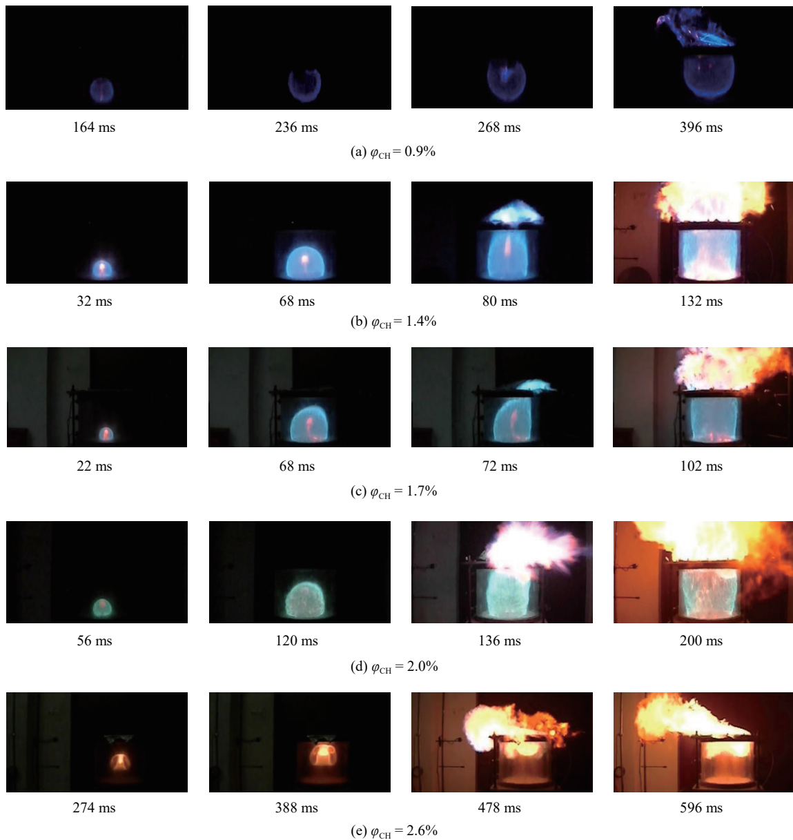
图 5 不同初始体积分数的油气爆炸火焰传播图像
