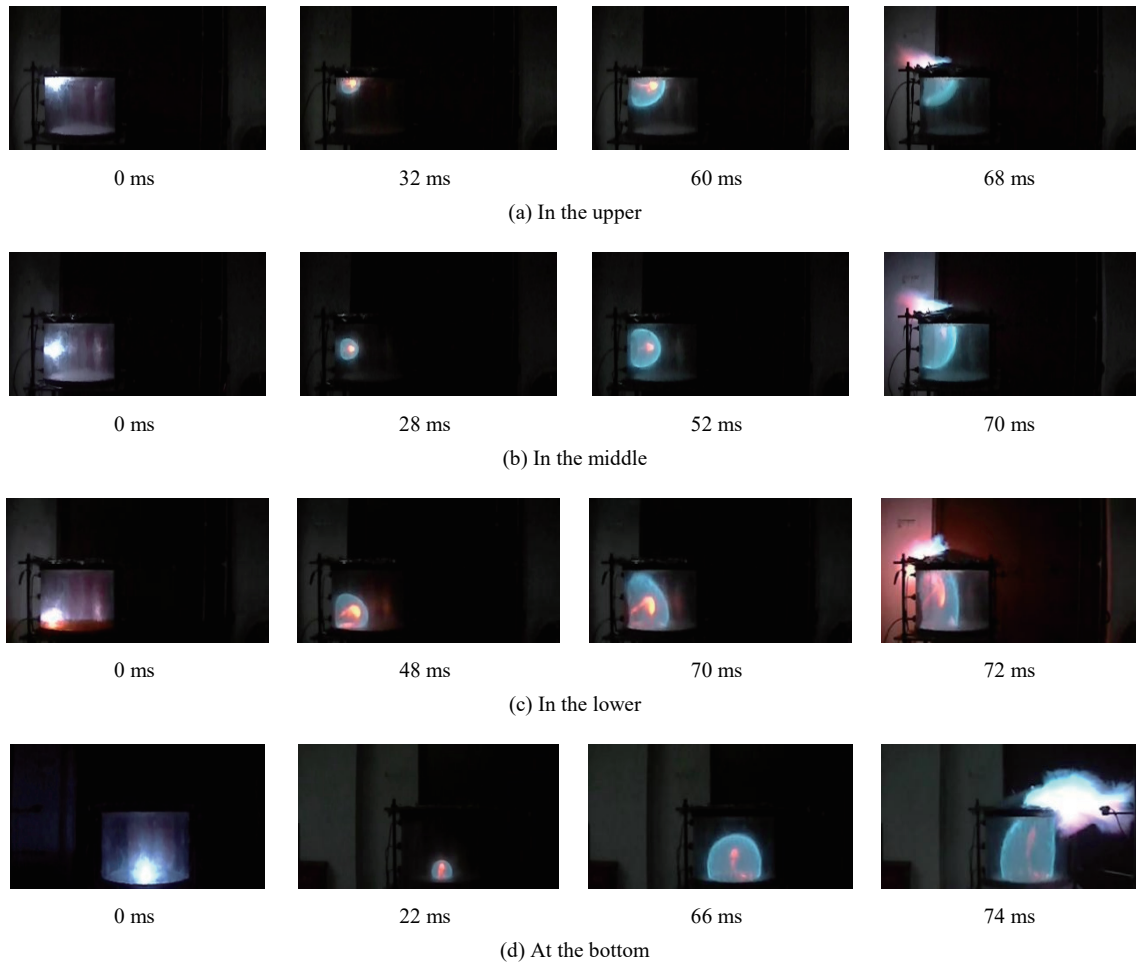
图 6 不同点火位置油气爆炸罐内火焰传播图像
