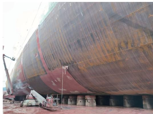
图 2 船壁面高压水射流除锈
