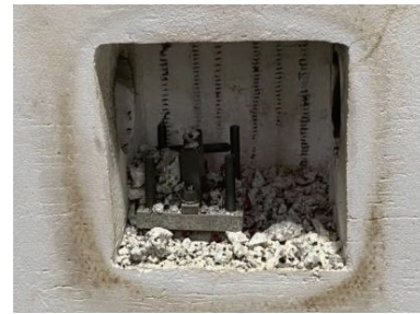
图 6 800 °C 实时高温破碎试件
