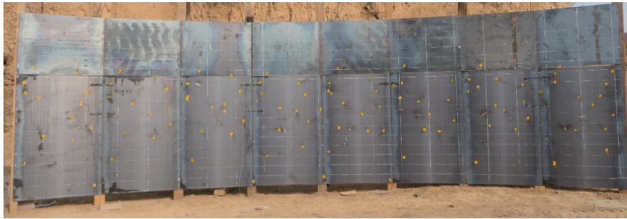
图 17 威力半径 10 m 处破片分布图(战斗部 A_2 )
