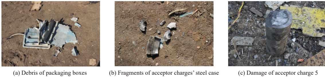
图 5 无防护措施殉爆试验后现场图 Fig. 5 Photos of SD test without protective design
