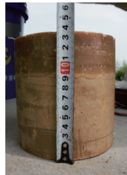
图 3 TNT 药柱尺寸图
