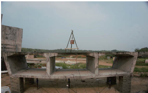
图 2 箱梁爆炸试验现场布置图
