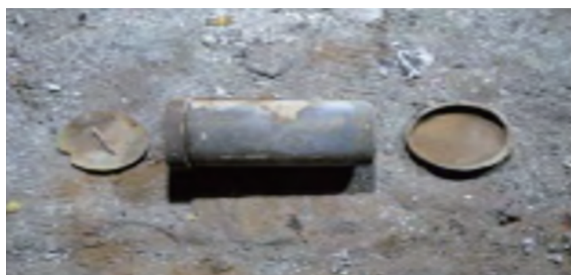
图 5 3.3 °C/h 升温速率下烤燃结束后回收的实验弹体
