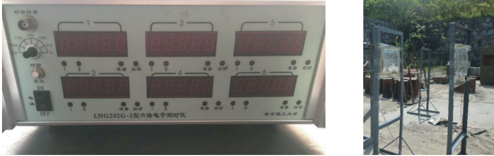
图 4 LNG202G-2 型六路电子测时仪与测速靶
