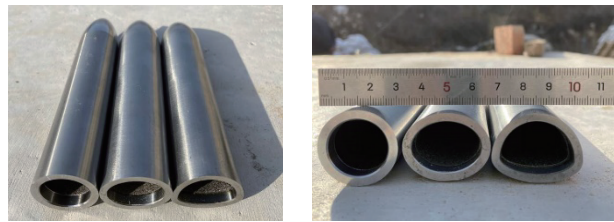
图 2 加工后的三种截面弹体
