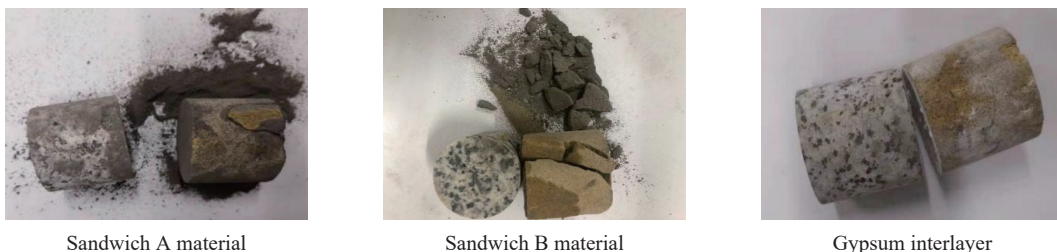
图 6 不同夹层材料岩体的破坏形态
