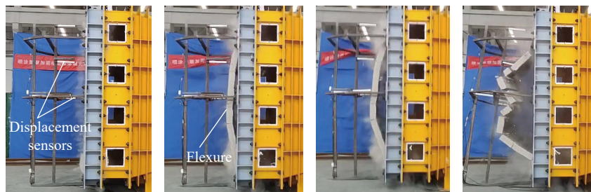
图 6 墙体 1 变形和倒塌过程
