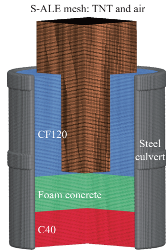
图 2 组合式防护结构预制孔装药爆炸试验数值模型 Fig. 2 Numerical model of blast test on composite protective structure
