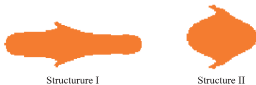
图 24 两组结构的弹丸形态( 30\text{ }\mu\text{s} )
