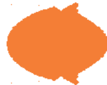
图 25 弹丸成型形状( 30\text{ }\mu\text{s} )
