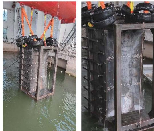
图 8 试验模型的水下爆炸变形
