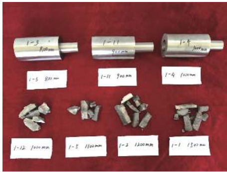
图 5 不同落高落锤试验的回收照片
