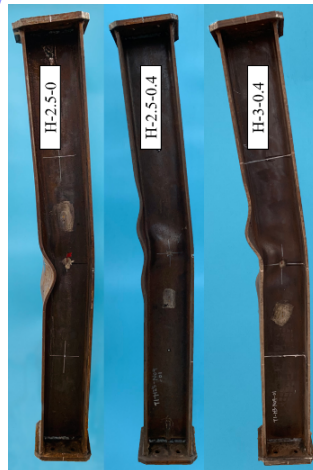
(b) 剩余承载力试件破坏模式
