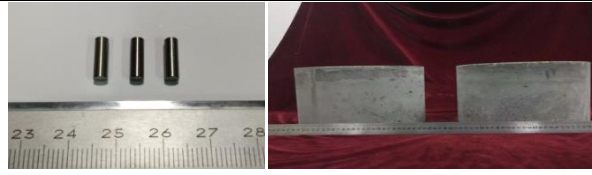
图 2 93W 钨合金柱形弹体和混凝土靶
