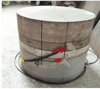
图 5 PVDF 压电应力计在靶体中埋设实物图
