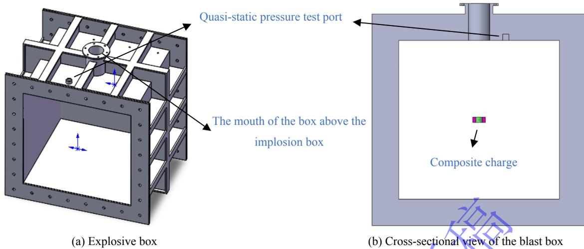
图1 爆炸箱体的三维模型
