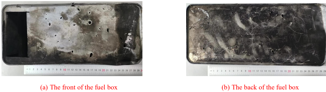
图9 活性材料壳体破片对油盒的毁伤效果
