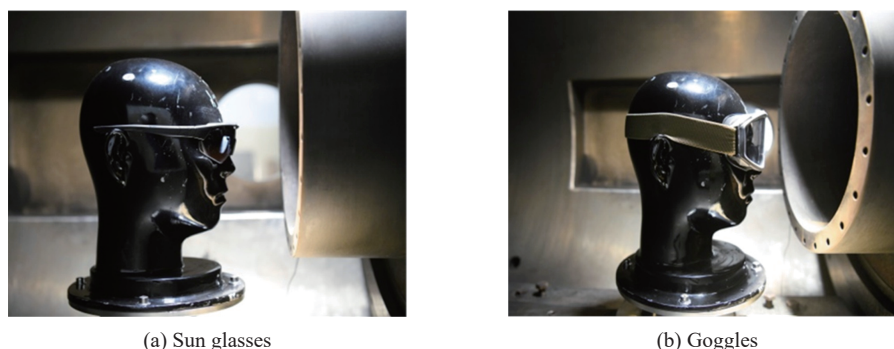
图 2 太阳镜和风镜的防护性能测试实验装置
