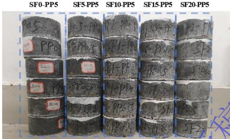
图 1 SF-FRC 试件实物
