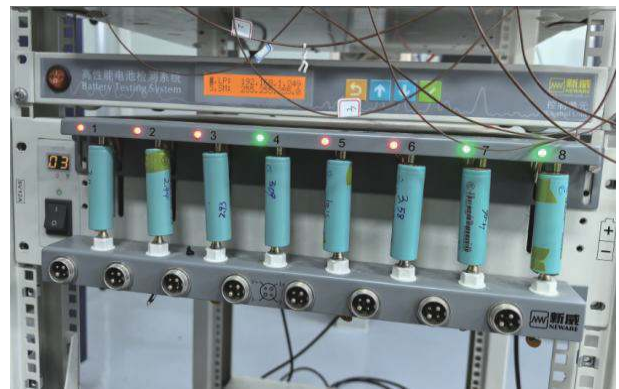
图 1 充放电循环测试系统 Fig. 1 Battery cycling test system
