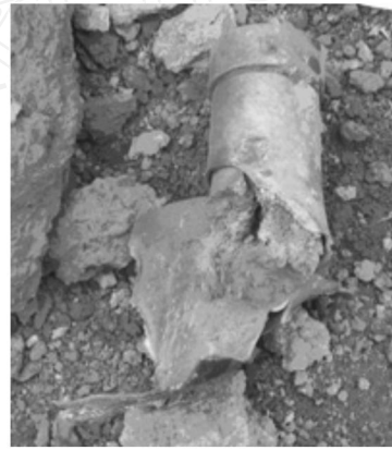
图5 殉爆距离为 300 \text{ mm} 的殉爆实验后被发炸药照片
